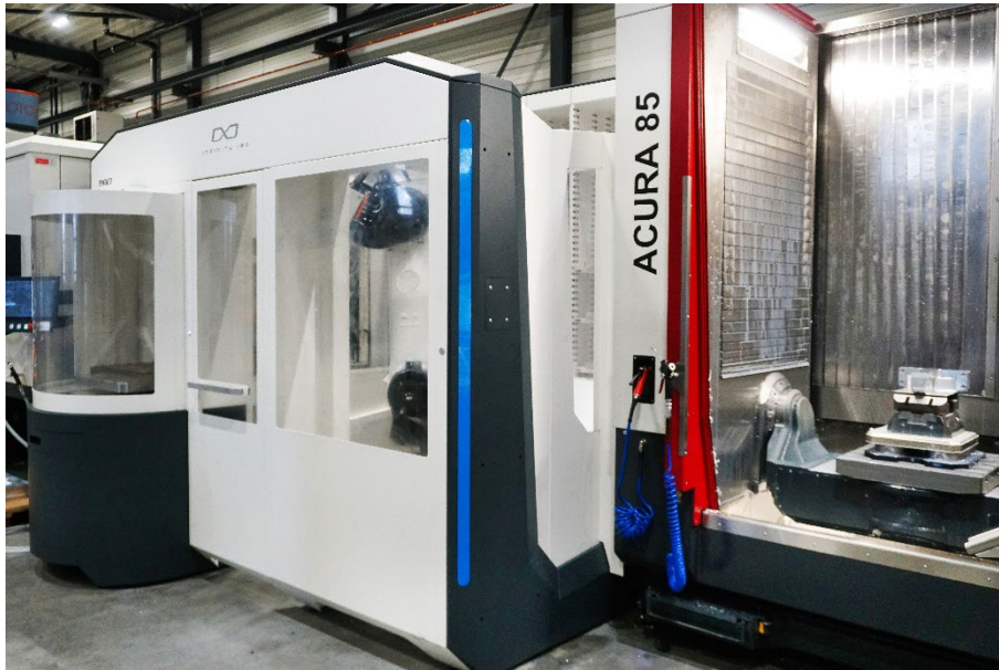
Bild 2: Wenige Monate später wurde mit der ACURA 85 ein 5-Achs-Bearbeitungszentrum angeschafft, das im Verbund mit einem Produkthandling-Modul eingesetzt wird.
