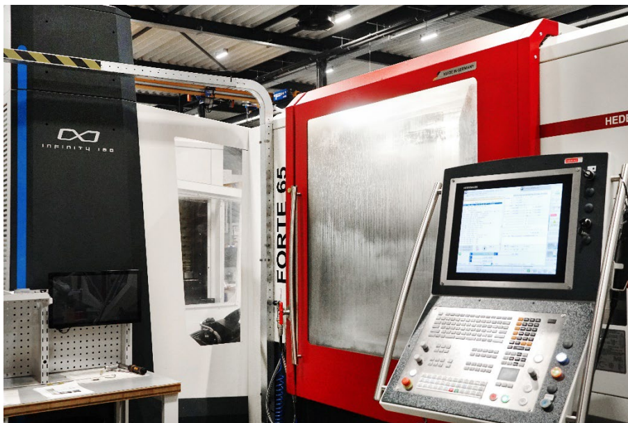
Bild 1: Das 3-Achs-Bearbeitungszentrum FORTE 65 wurde an ein Palettenhandling-Modul auf der Infinity-Plattform angebunden. Durch die seitliche Beladung bleibt der Arbeitsraum jederzeit voll zugänglich.
